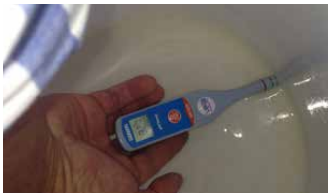
pHmetro y termómetro digital de lectura inmediata.
